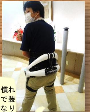
簡単に装着でき、慣れた人は1分以内で装着できるようになりました。重量は約2.9kg、操作ボタンは3つです。作業に合わせて5段階のアシストが選択できます。
